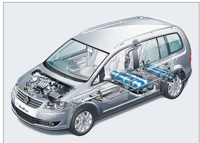
PLATZSPAREND Die vier Gas- und der Benzintank sind als Unterflurlösungen integriert und schränken weder das Innenraum- noch das Ladevolumen ein. HO
