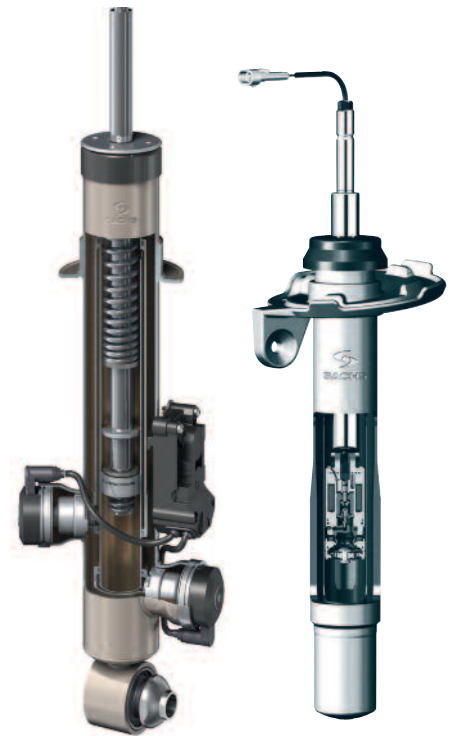
A gauche, Économie du volume: amortisseur CDC avec vanne proportionnelle intégrée; à droite, Mise en réseau intelligente: la combinaison de la stabilisation de roulis active et du CDC2e augmente la sécurité et le confort
