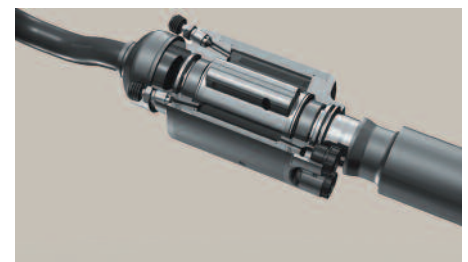
Die Wankstabilisierung ARS (Active Roll Stabilization) minimiert die Seitenneigung eines Fahrzeugs bei Kurvenfahrt und gleicht sie bis zu einer gewissen Querschleunigung (etwa 0,5 g) sogar ganz aus
