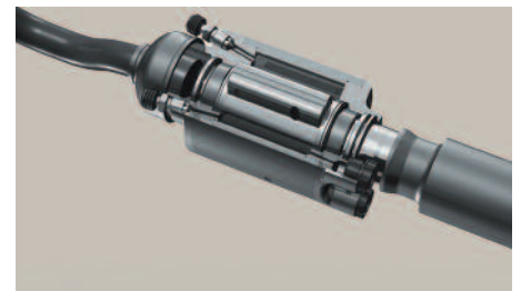
La stabilisation de roulis ARS (Active Roll Stabilization) réduit l'inclinaison latérale de la caisse lors de l'inscription en virage et la compense quasi totalement jusqu'à une certaine accélération latérale (0,5 g env.)
